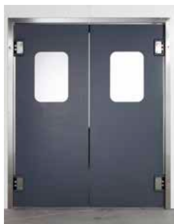
2-flüglige Ausführung Öffnungswinkel 2 × 90 ° Breite in mm: 800 - 3200 Höhe in mm: 1800 - 4600
